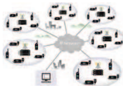
Rys. 4. Przykładowa struktura sieci radiowej z przebiegnikami RoIP Źródło: Kenwood Communications
