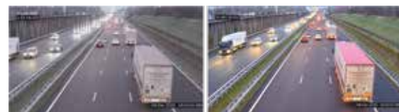
Fot. 2. Obraz z kamery bez funkcji Starlight X oraz z włączoną funkcją Starlight X
