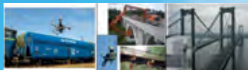
Rysunek 1. BSP podczas monitoringu transportu kolejowego oraz inspekcji mostów drogowych
